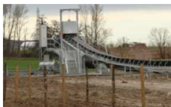
Les changements de direction de la bande transporteuse sont identifiables du fait des dispositifs comme celui-ci, entre les sites de Pissou et Tanéria. Le même est présent à côté de la RD6 après le passage sous tunnel. Ci-dessous la zone de chargement des camions et de stockage, site de Pissou en face de la station d'épuration.
